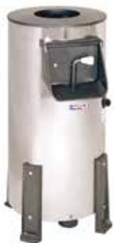
پوست کن ایستاده استیل ایرانی قدرت: ۰/۴ kw - ۰/۵ Hp گنجایش: ۱۰ kg خروجی در ساعت: ۵۰۰ kg Peeler
